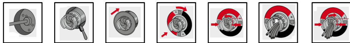
구조물 타공 타공부 청소 실링와셔 장착 마감와셔 장착 차단부 개방 케이블 인입 차단부 폐쇄
