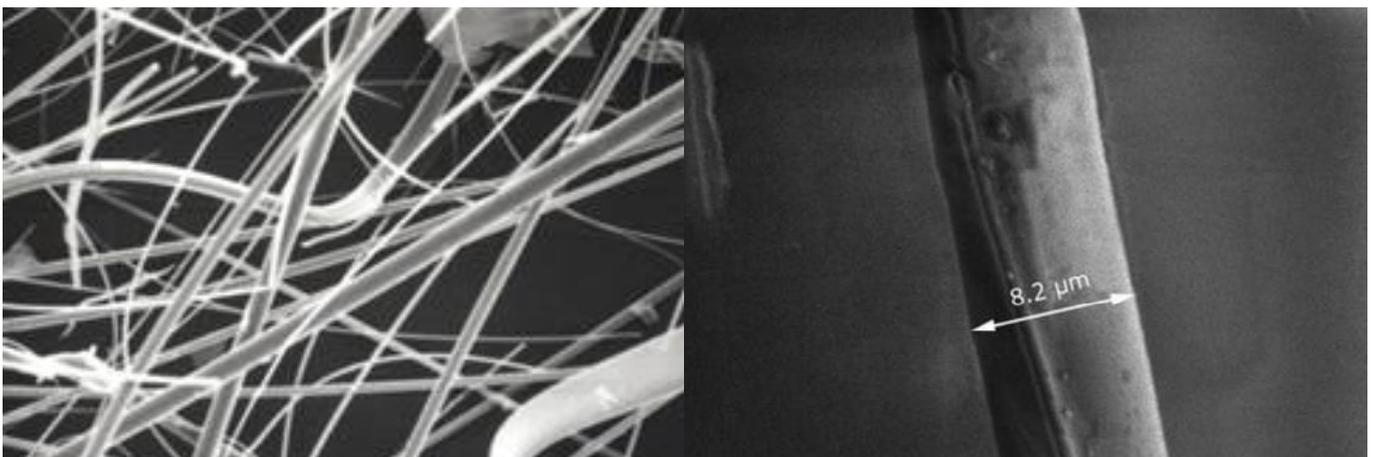
그림 3: 방화보드의 미립자 크기는 평균 직경 2~10 $\mu$ m로 제조 프로세스에 따라 크게 차이 남 [7] [8]
