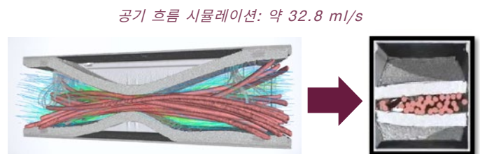
그림 8: 케이블 관통부에 맞추기 위해 팽창성 라이너 패드 주위에 고무 밴드를 장착한 경쟁사 통로 장치 - 2016년 6월 외부 공인 기관 폴 슈러 연구소에서 실시한 CFD 시뮬레이션
